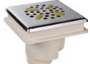
Aus ABS-Kunststoff mit einer Edelstahl-Blende rechteckig (AISI 316) V4A. Bodenablauf 2" 90° x 2 1/2" und 63 mm Klebe-Anschluss.
