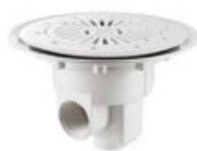
Abgang nach unten verschlossen, kann bei Bedarf geöffnet werden, Durchfluss max. 14m³/h, Fließgeschwindigkeit 0,5 m/s.
