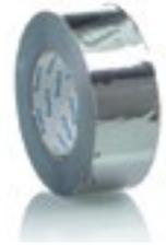
Träger: Aluminiumfolie, weich, glatt. Dicke: 0,03 mm, Klebstoff: Acrylat. Abdeckung: klebstoffabweisende Polyethylenfolie.
