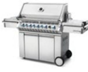
Typ PRO 665. WAVE Stabgrillroste aus Edelstahl 9,5 mm. Große, von vorne zugängliche Fettauffangschale. SIZZLE ZONE Infrarot Seitenbrenner. NIGHT LIGHT Bedienelemente und Innenbeleuchtung für stilvolles Grillen bis in die Nacht. Als Propangas-Gerät erhältlich. Luxuriöse, hohe und gleichzeitig platzsparende LIFT EASE Rollhaube mit glänzenden Chrom-Akzenten und Griff. Premium Seitenablagen aus Edelstahl mit intergrierten Getränkehaltern ... u.v.m.
