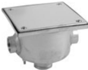
Zum Verdrahten von Unterwasser-Scheinwerfern, aus Edelstahl (V2A), mit zwei PG-16-Verschraub. und einem R 3/4" IG-Anschluss.
