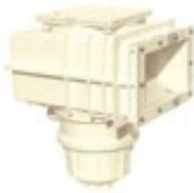
V20 Skimmer aus ABS-Kunststoff, Anschluss Ø 63 mm, mit V4A Niro-Flanschsatz und 2 EPDM-Dichtungen weiß, 10 V4A Schrauben.
